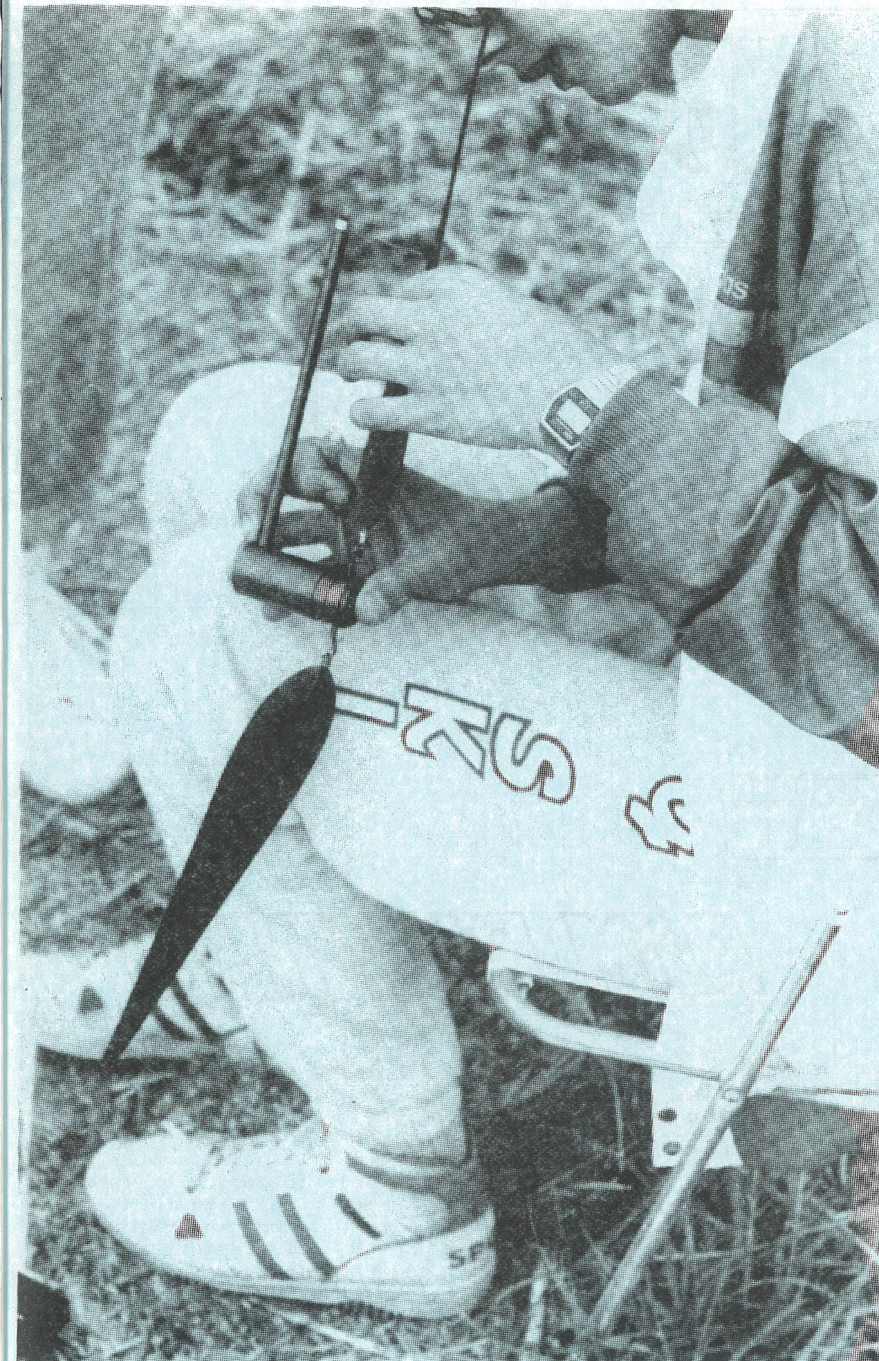
Instrument pour vérifier et mesurer le pas de l'hélice. Steigungslehre, zur Einstellung und Kontrolle der Propeller Steigung.
