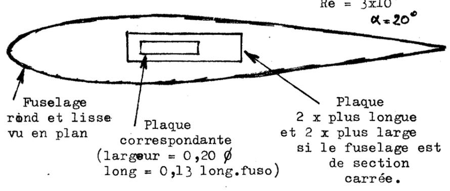
Lumineux, n'est-ce pas ? Le fuselage "streamline" traverse l'air sans le déranger beaucoup. Le fuselage carré dérange 4 fois plus, si l'on peut dire. C'est dû aux frottements sur les parois latérales et aux tourbillons décollés sur le dessus du fuselage ( en attaque positive ).
