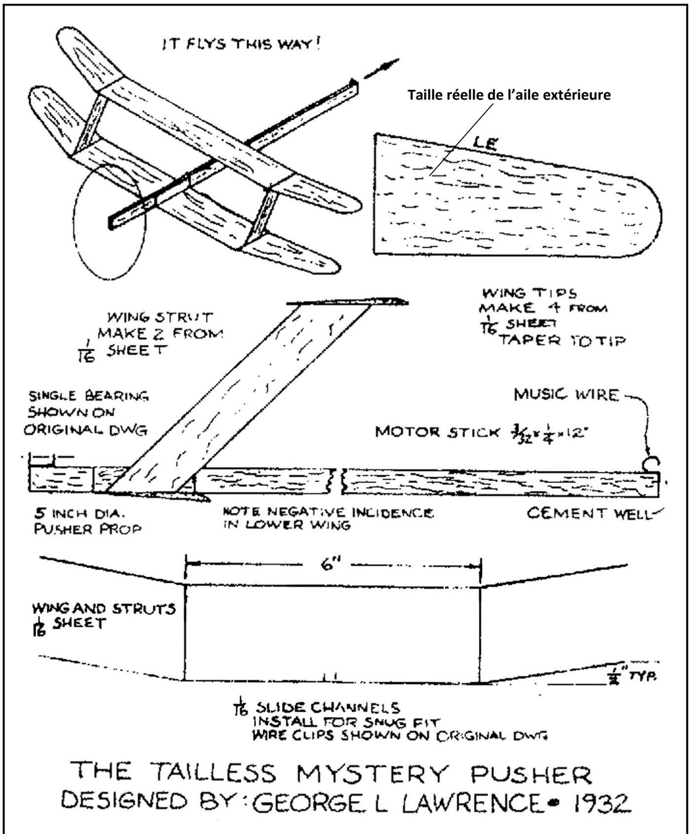
Envergure 30 cm. Longueur 30 cm. L'aile inférieure coulisse sur le fuselage pour régler le C.G.
