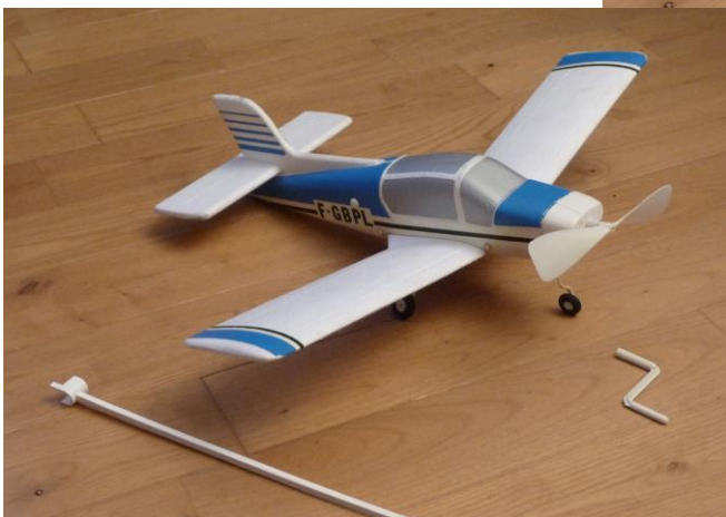
Approximativement : nez-hélice 20 g, moteur 15 g, cellule 30 g.
