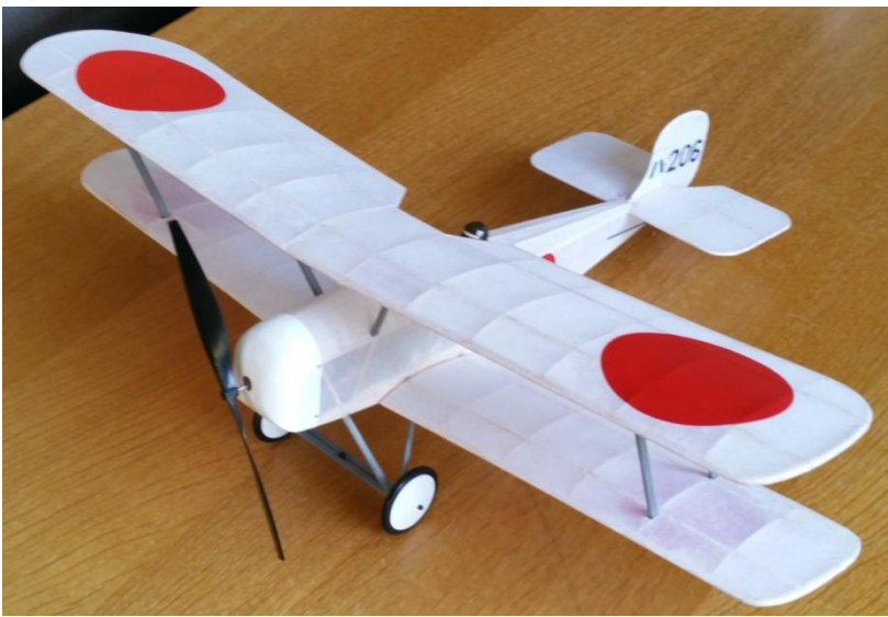
Mitsubischi 1MF3 de Philippe Lacourt inspiré du plan de Roger Aime. Envergure 36 cm, poids approximatif 40 g. L'ensemble propulsif semble venir d'un Minium 8 mm. Détails de finition en cours.....
