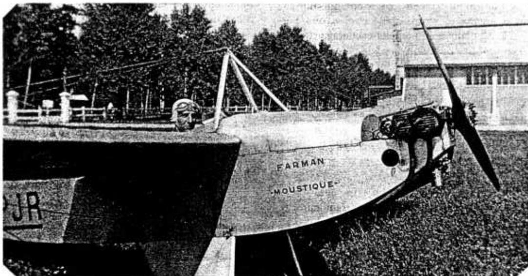
*Caractéristiques.* — Envergure, 8m; longueur, 6m,50; hauteur, 2m; surface portante, 10m<sup>2</sup>,50. Poids à vide, 150kg; pilote, 8 kg; bagages, 10kg; essence, 10kg (21) huile, 3kg. Poids total en vol 249kg.
