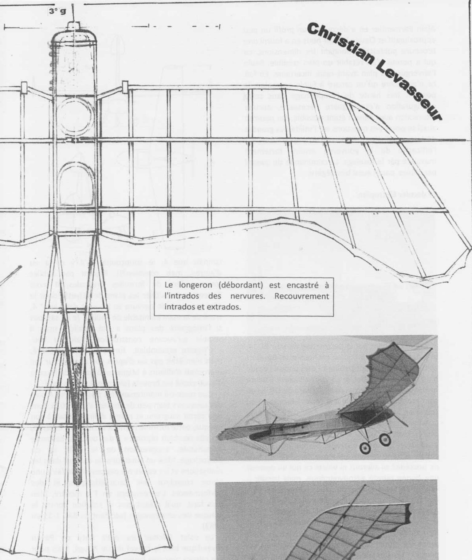
Le longeron (débordant) est encastré à l'intrados des nervures. Recouvrement intrados et extrados.
