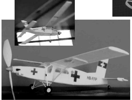
Le Pilatus PC-6 au 1/60 de Peter Keller est construit principalement en papier de 50g/m². Il mesure 25,5 cm d'envergure et pèse 2,65 g sans moteur.
