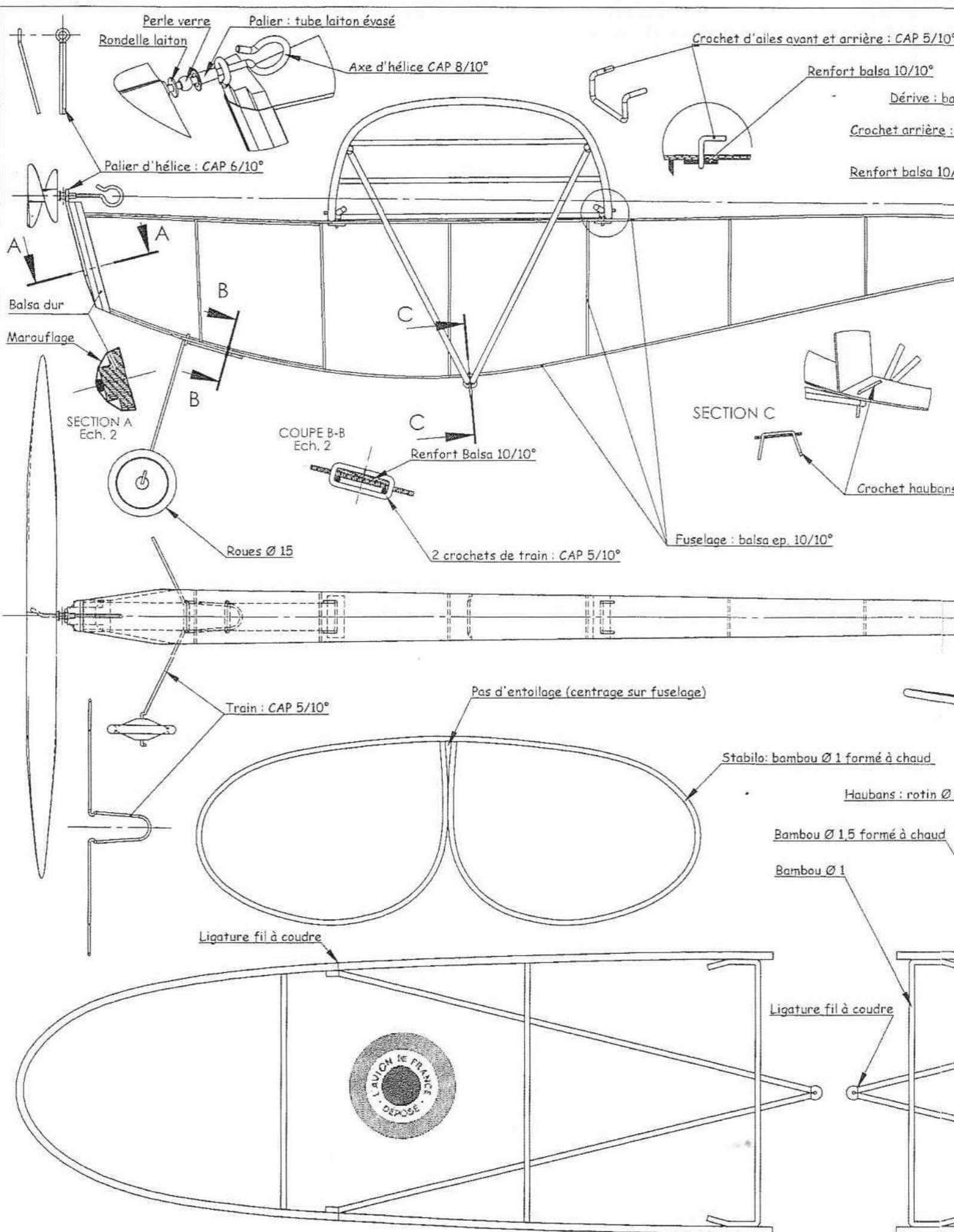
*Entoilage ailes et stabilo extrados seulement, dérive sur une seule face, fuselage sur les deux flancs.*
