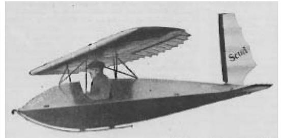
Le microscopique Scud (envergure 7,5 m) a été un des planeurs présentés expérimentalement à Nottingham. Couleur : vert foncé et blanc. Il a connu une évolution à grand allongement et aile trapézoïdale.
