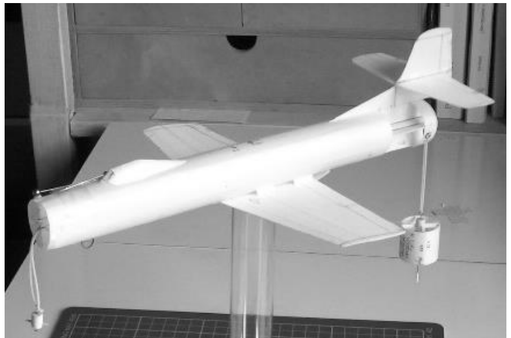
Le modèle expérimental , avec, ci-dessus la turbine à sa taille réelle.
