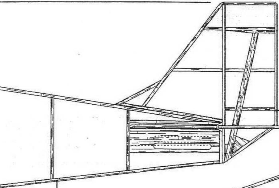
Stabilisateur et dérive en balsa de 1,5 mm léger. Les gouvernes sont séparées de la partie fixe après entoilage pour plus de facilité
