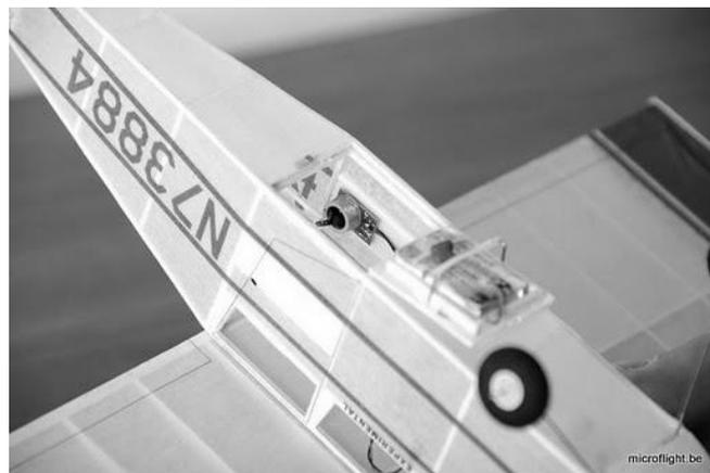
Collez en place les actuateurs et réalisez les commandes. Elles sont constituées d'un longeron en balsa de 1.5 x 1.5 mm. La « chape » côté actuateur est un coude en métal non ferreux (sans quoi le fonctionnement de l'actuateur serait perturbé). Du côté de la gouverne il n'y a aucun soucis, de la corde à piano de 0.4 mm fera parfaitement l'affaire.
