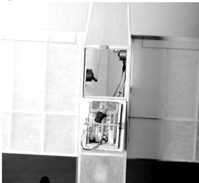
Passez à l'installation de la trappe d'accès à la radio. Découpez la trappe dans du balsa de 1.5mm et collez les renforts en balsa 3x1.5mm sur lesquels elle repose. Aménager la partie intérieure de la trappe en y faisant un petit logement pour l'accu et réalisez deux petits crochets en corde à piano de 0.8mm qui serviront à recevoir un petit élastique qui maintiendra la batterie en place.
