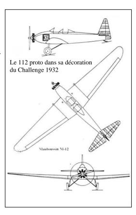
Le nouveau modèle utilisait presque sans modifications les ailes et empennages du M-11, le gain de poids (17%) et de finesse apportant un plus substantiel à l'ensemble des performances.
