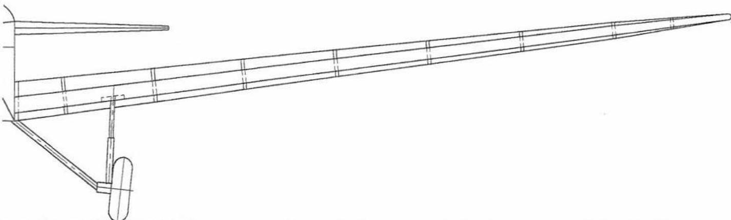
Toutes les baguettes du fuselage sont en Balsa dur 1x1
