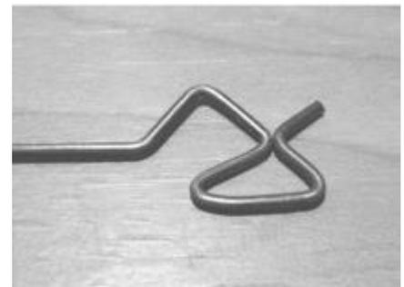
Le modèle du centre est le plus compliqué, mais c'est celui qui me paraît le plus intéressant car le moteur ne peut s'en échapper à la fin du déroulement, même s'il est très long (bimoteur par exemple).
