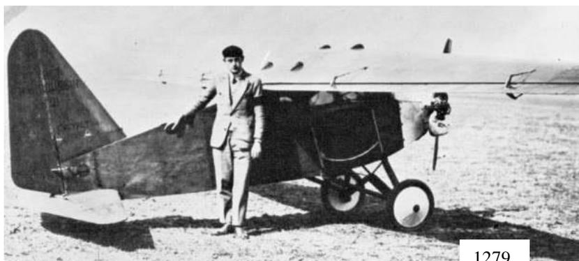
A gauche Fauvel devant sa monture. On remarquera le train d'origine, les deux carburateurs séparés placés dans des « économiseurs », les fixations d'aile au carré permettant de ranger celle-ci en long, dérive rabattue.
