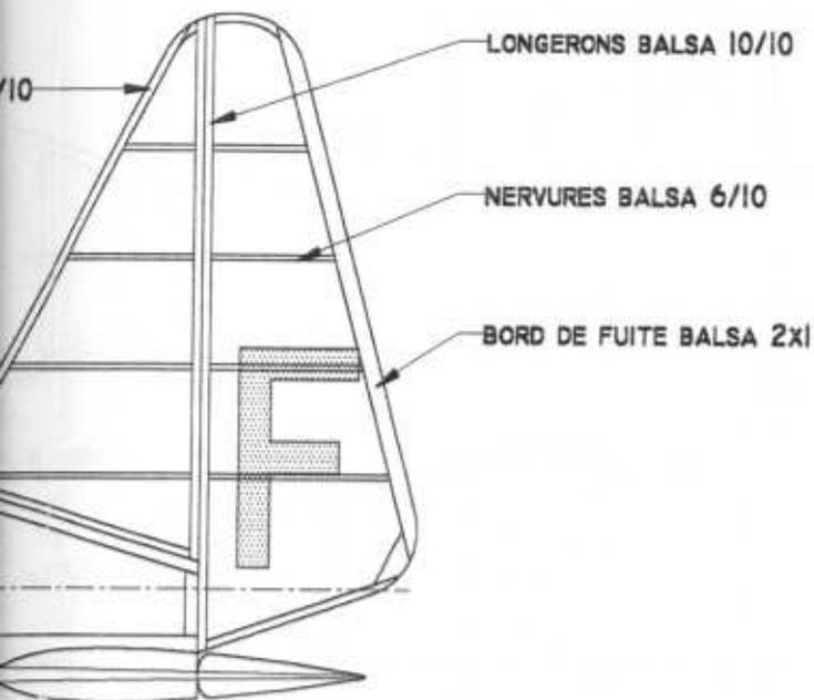
**NOTA:** LA DÉRIVE ET LE STABILISATEUR SONT MIS EN FORME PAR PONÇAGE APRÈS ASSEMBLAGE
