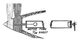
un couple moitié), mais la longueur équivalente est moitié également. Dernier problème : la compression s'exerce sur le tube, et non sur le nez, qui n'est pas maintenu en place. Il faut donc prévoir un blocage. On remarquera que rien n'assure l'égalité des vitesses de rotation des deux hélices, les frottements n'ayant aucune raison d'être égaux dans les deux sens.
