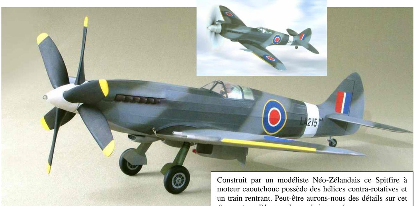
Construit par un modéliste Néo-Zélandais ce Spitfire à moteur caoutchouc possède des hélices contra-rotatives et un train rentrant. Peut-être aurons-nous des détails sur cet étonnant modèle pour le prochain numéro.
