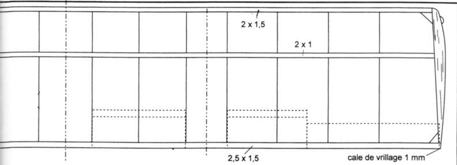
Réglage : tourne à gauche avec 1° d'axes à gauche, vrillage indiqué et dérives braquées 5 à 10°
