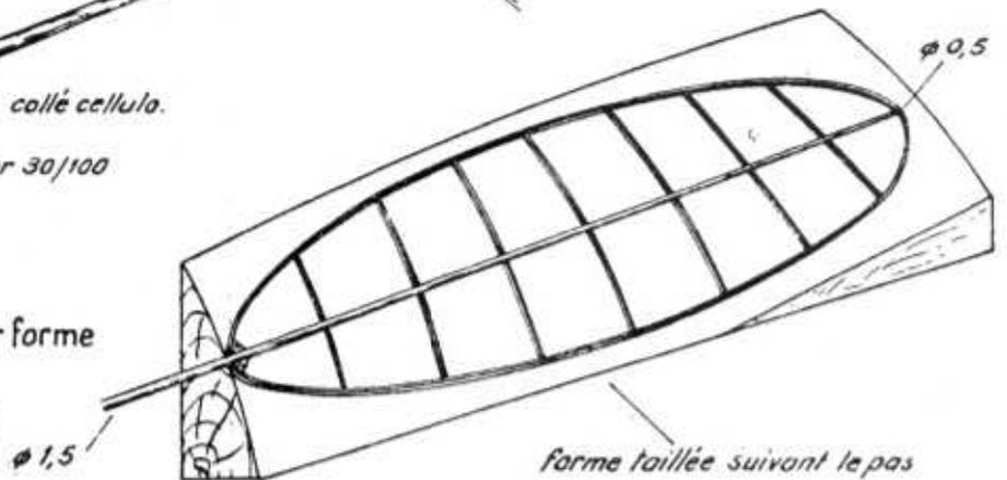
Nota : Pour l'assemblage, utiliser une colle cellulosique. Attention!.. cette colle attaque le microfilm. Avant le recouvrement, avoir soin d'enlever toutes les aspérités sur la structure.
