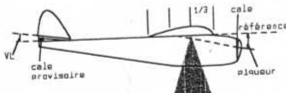
VL : V longitudinal . Différence d'incidence entre l'empennage et l'aile , mesurée pour des raisons pratiques par rapport à l'intrados de l'aile
