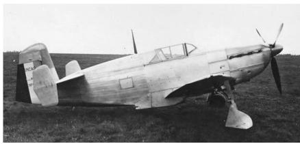
C'était un assez petit avion, avec une charge alaire élevée. Il comportait donc des volets de courbure importants et des fentes de bord d'attaque. Ses lignes angulaires étaient dues à la recherche de la rapidité de construction par des moyens innovants comme la soudure électrique par points.
