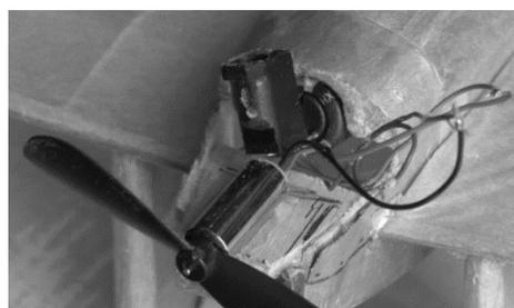
*Le condensateur est caché sous le capot, le moteur 12 x 6 collé sur une plaque de 20/10, le chargeur est laissé provisoirement apparent en biais.*
