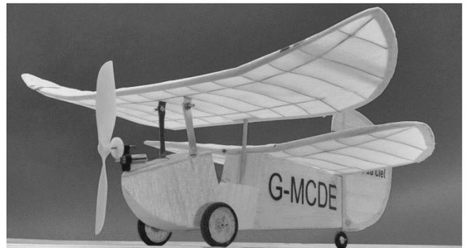
Pou RC semi-peanut de Heinrich Eder. 26 cm, 11 g, récepteur Deltang 0,3 g, servo micro-linéaire 1,2 g. On notera l'aile principale à incidence réglable comme sur le vrai !
