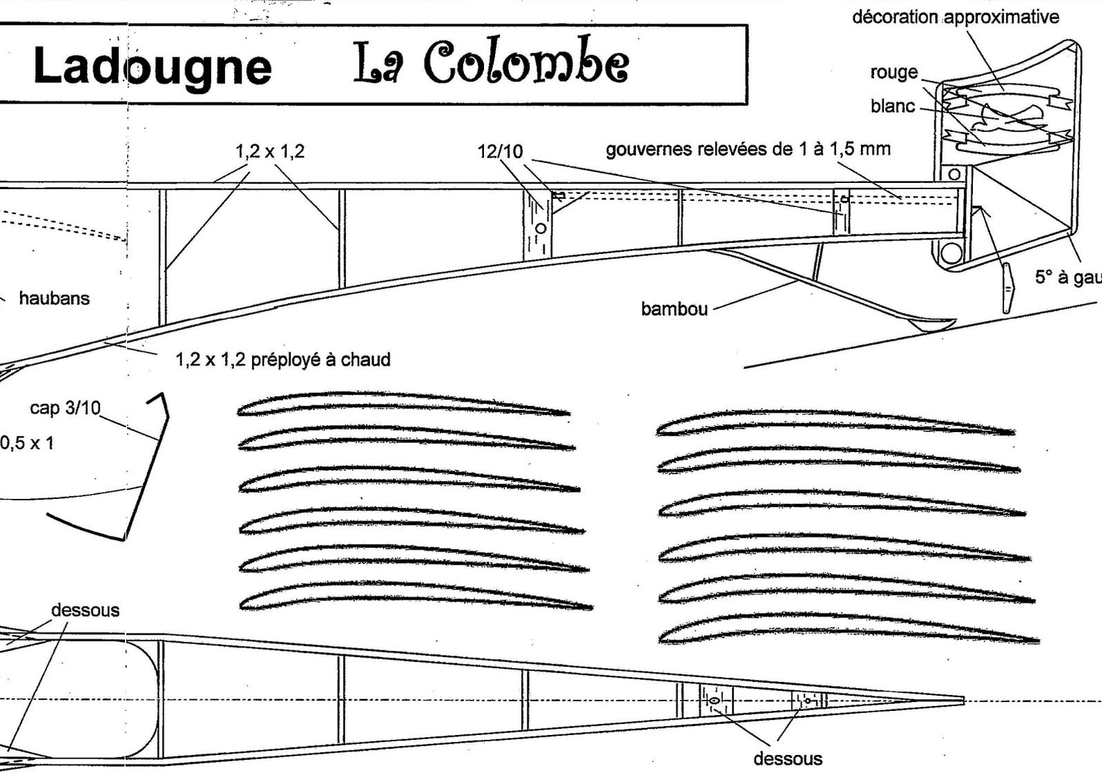
Hélice 130 mm pas 1,6 Moteur une boucle de 2 à 2,2 mm longueur 300 à 350 mm
