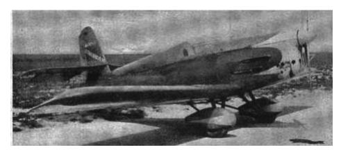
d'un défaut de refroidissement d'huile. Il existe plusieurs trois-vues de cet avion, dont les dimensions données (longueur, envergure, corde) diffèrent quelque peu. Le plan que j'en ai tiré (voir p 2230) est donc forcément une interprétation. On remarquera, à Angers, le capot différent, la présence de karmans (presque invisibles) et de plaques carénant la fente de la direction. Les dessins de Barthélémy (habituellement précis) semblent monter une cabine encore
