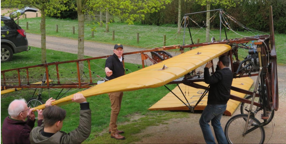
Remontage du Blériot. Moteur de Dyna Panhard des années 50 faisant 40 ch.
