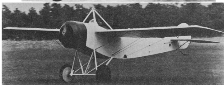
Construit en quelques semaines par Salis pour la mini-série Le Temps des As (suite des Faucheurs de Marguerites), il utilisait une aile de Tiger Moth et un moteur de Piper Cub. Envergure 9 m, longueur 6,3 m, vitesse max. 145 km/h. Une maquette facile et originale pour les vacances !
