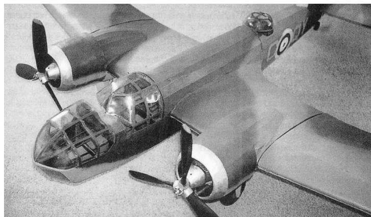
Le Blenheim (photo de *Aéroplane* 12/2004) de 146 cm d'envergure, comporte donc le fameux "Moore drive" avec au moins deux écheveaux, train rentrant et ressortant et réglage associé de l'incidence de l'empennage ! On remarquera la forme assez simple des cardans, dont certains sont de simples fourches ce qui rend le démontage et certains réglages plus faciles. Le schéma ci-contre est probablement celui du Scion.
