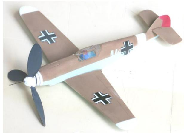
Le Goupy, médiocre performeur sous caoutchouc (6 g de lest!) est en reconversion avec un moteur KP-00 et un condensateur de 10F qui prend presque exactement la place du réservoir d'essence. Utilisation très facile, mais la charge est rapide : pour les premiers essais, une seconde suffit! Et pas moyen d'utiliser un contrôleur Zombie. Premiers essais encourageants.
