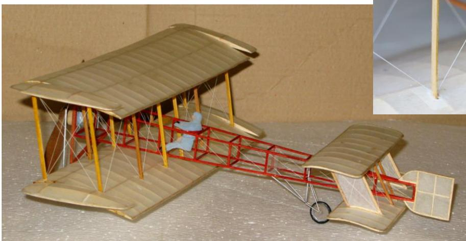
A l'origine, l'avant du fuselage était bien trop faible, d'où ces renforcements inesthétiques. Il aurait fallu utiliser un petit jonc de carbone à l'intérieur et un croisillonnage métallique pour les premières baies.
