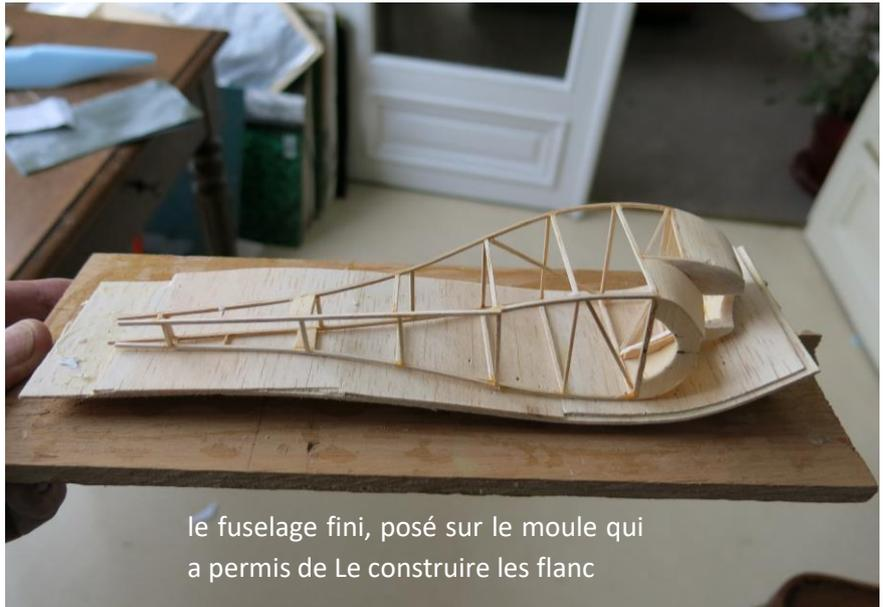
le fuselage fini, posé sur le moule qui a permis de Le construire les flanc
