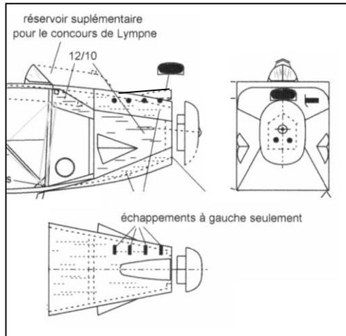
la faible qualité de la reproduction, on y voit nettement la présence d'un réservoir supplémentaire venant jusqu'au pare-brise, qui est absent sur d'autres photos. Les échappements des 4 cylindres sont également bien visibles avec une forme de capot légèrement différentes de la droite, ainsi qu'une sortie d'air de refroidissement, symétrique de la droite. L'appuie-tête à une section polygonale et non arrondie comme sur le plan du n° 59.
