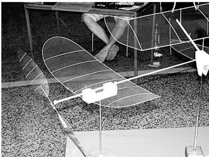
*Le modèle de Lutz Schramm, très semblable à celui dont nous avons donné le plan dans notre n° 45. A noter la cabane en carbone, assez courte, très décalée, et l'hélice en carbone (voir n° 63) qui permet un longeron réduit. Lutz utilisait du Tan 05/99 1,27 g/m 0,593 g. Remontage 1750 tours, 100 tours restants. Meilleur vol sans guidage!*
