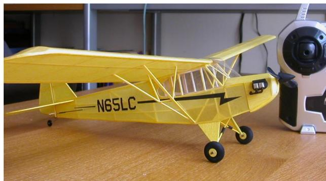
saumons d'ailes et empennages moulés sur formes en carton, train d'atterrissage en CaP 0,5, roues tournées dans de la mousse (le moyeu étant un petit tube plastique de bombe lubrifiante), entoilage papier japon.
