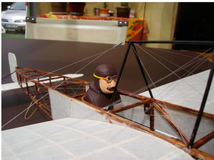
L'assemblage des mâts ne pose pas de gros problème puisque ce sont des tubes et qu'il suffit de les enfiler comme des perles sur un fil que l'on fixe à la structure puis on immobilise avec une goutte de cyano.
