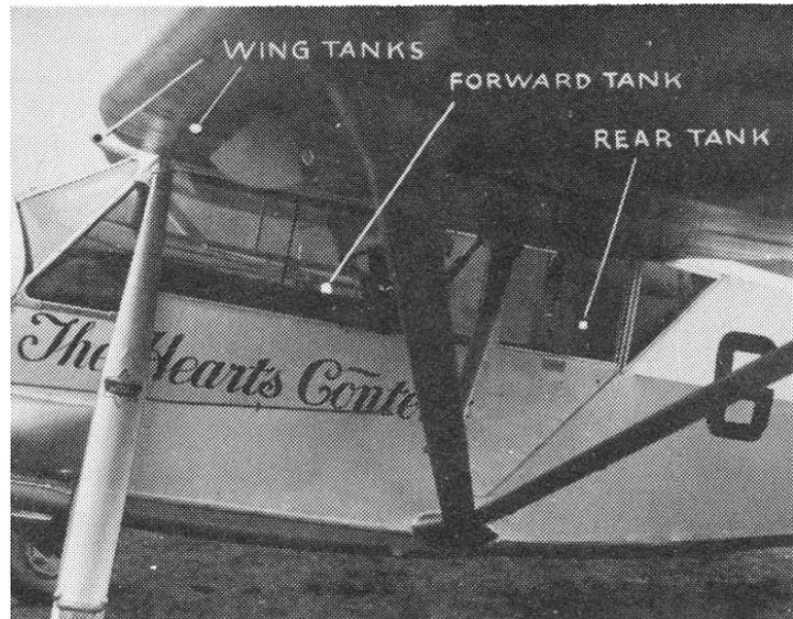
Jim Mollison était en place arrière , entre un réservoir avant de 300 l et un arrière de 80 l. Pour l'époque l'instrumentation était assez moderne, mais pas de pilote automatique et pas même de blocage de commandes. Décollant d'Irlande, le pilote écrasé de fatigue se posa 30 h après dans le Maine, alors que l'appareil avait encore de quoi gagner New York.
