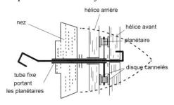
touche pas l'hélice avant), on pourrait avoir un ensemble serré par la traction du moteur, des planétaires cylindriques étant pris entre deux « cloches » plates ou mieux deux plateaux cannelés (à trouver!) solidaires des hélices. Montage pouvant être assez compact pour une Cacahuète (à gauche).
