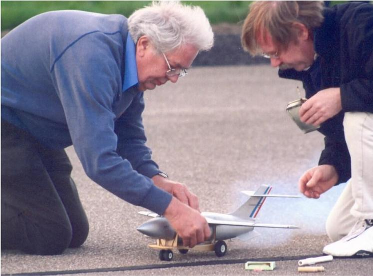
Derek prépare une micro turbine de seulement 32 mm de diamètre. C'est peut-être le prototype de cette turbine qui équipe le Cougar que j'ai trouvé sur Internet. Il mesure 42 cm d'envergure et la turbine est motorisée par deux KP 00. Nous en reparlerons certainement.
