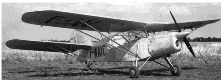
**Morane MS 600 F-WCZT** : Structure métallique entoïlée, moteur Mathis, du moins à l'origine. Encore un échec au test de vitesse ascensionnelle, mais de peu. Les qualités de vol étaient correctes, sauf pour l'utilisation des volets, considérés comme dangereux. Après changement de moteur et de train, il volera, sous CNRA, jusqu'en 1968.
