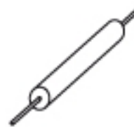
Après séchage, couper l'excédent de papier. Passer le tube au milieu de la roue et coller. Laisser sécher, couper l'excédent. Après séchage, retirer la corde à piano.
