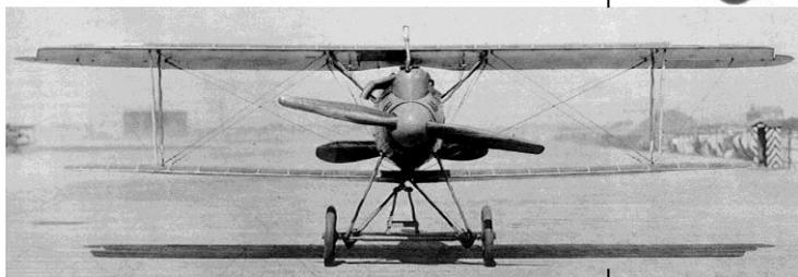
Sur la photo ci-dessus on voit le train très particulier, le radiateur décalé à droite invisible sur le plan, et la forme de l'échappement. En dessous modèle désarmé équipé d'un pare brise.
