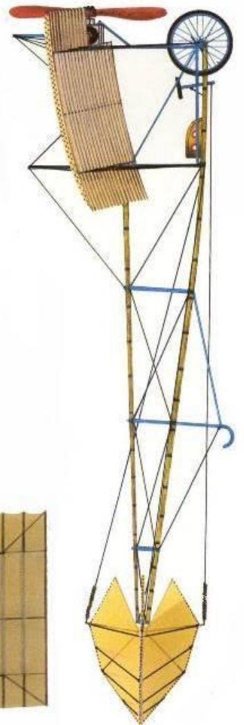
Remarque : comme celle du Musée de l' Air, cette Demoiselle possède un bord d' attaque d' aile et un périmètre d' empennage en baguette et non en câble (voir la fin de l' article de M. LEVEQUE)
