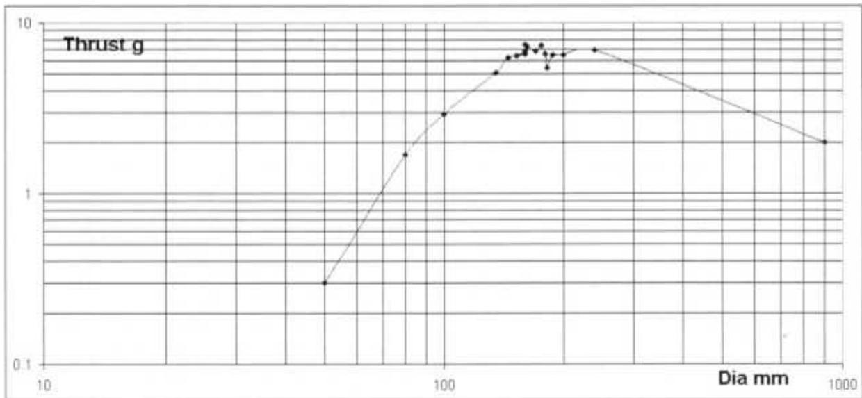
A partir de nombreuses autres mesures, et en interpolant au mieux, on peut obtenir la relation entre force de traction, diamètre de l'hélice, rapport de réduction et puissance du moteur.
