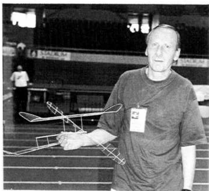
Hors concours, P.KELLER a réalisé plus de 20' avec ce F1D conforme aux nouvelles règles de la catégorie: 55 cm, 1,2 g et 0,5g moteur.
